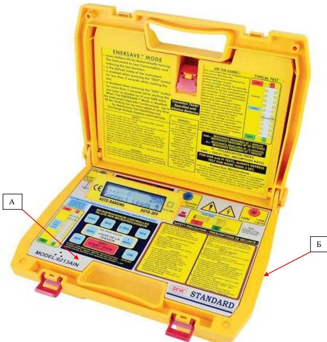
Рисунок 2 – Общий вид измерителей модификации 6213А IN, места нанесения знака утверждения типа (А) и знака поверки (Б)
