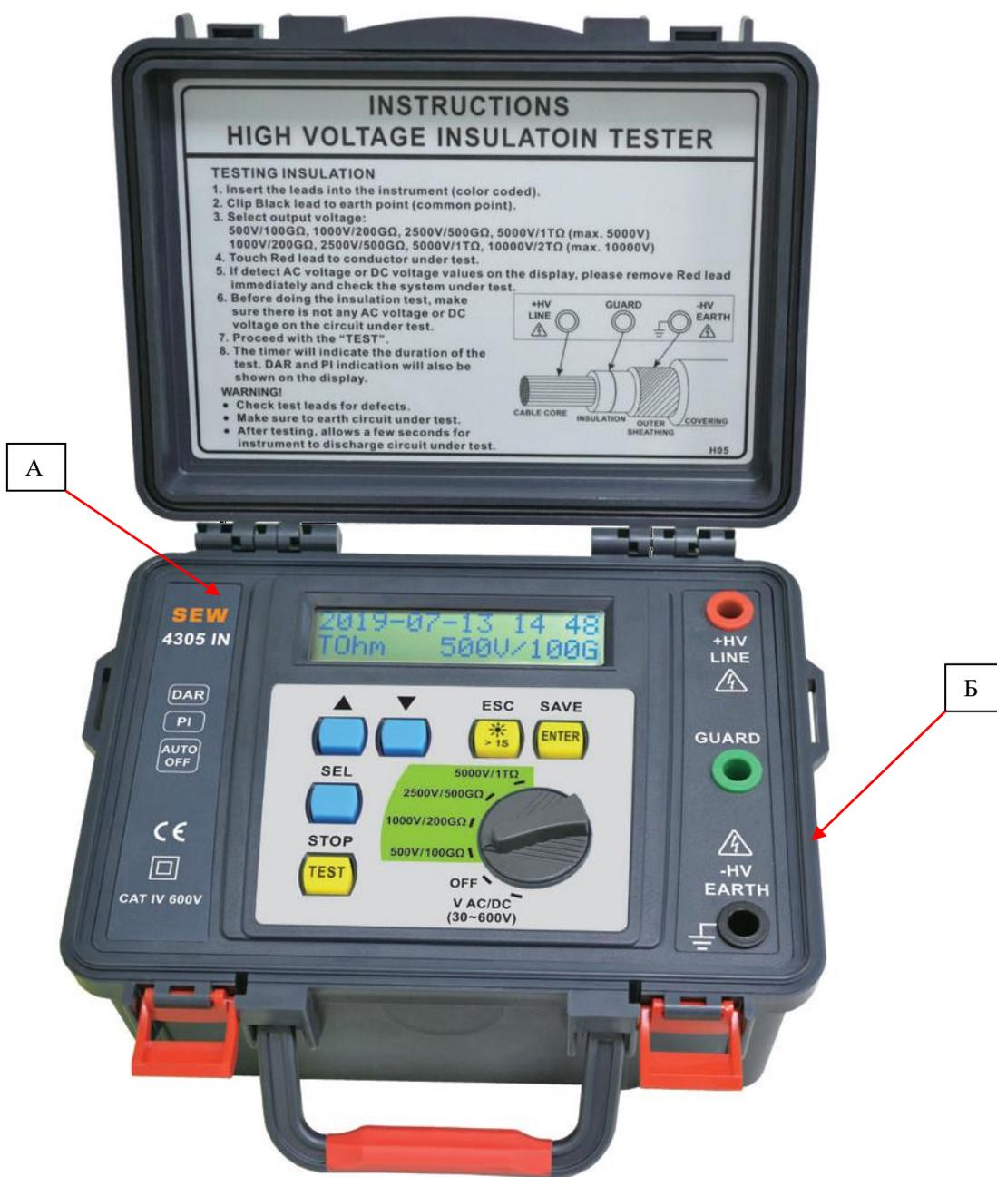
Рисунок 1 – Общий вид измерителей модификаций 4305 IN и 4310 IN, места нанесения знака утверждения типа (А) и знака поверки (Б)
