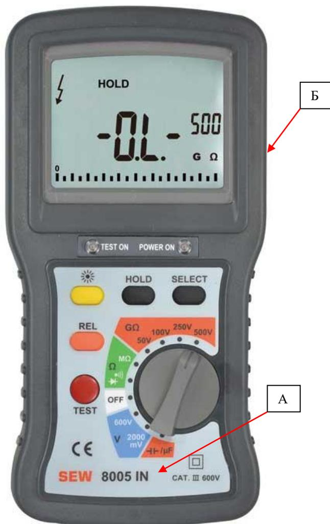
Рисунок 4 – Общий вид измерителей модификаций 8005 IN и 8010 IN места нанесения знака утверждения типа (А) и знака поверки (Б)
